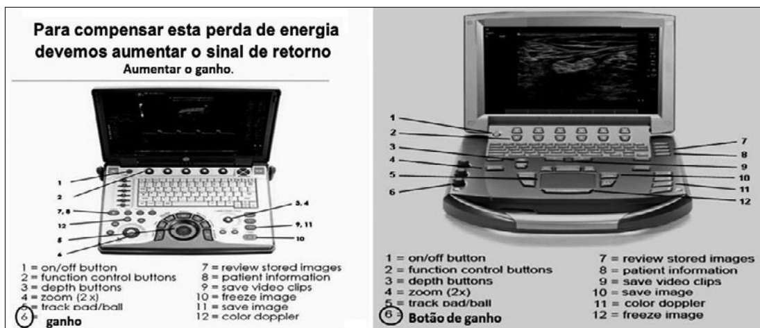
Figura 9. O sinal de retorno pode ser ajustado nos aparelhos de ultrassom através do botão de ganho.
