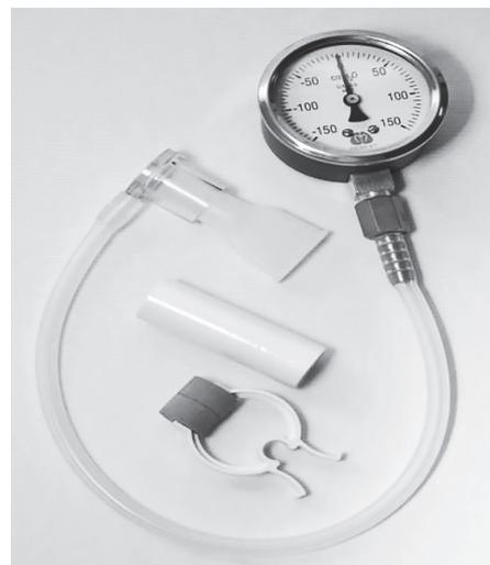
**Figura 17.2 –** Manovacuumeter analógico utilizado para verificação das pressões respiratórias máximas.
